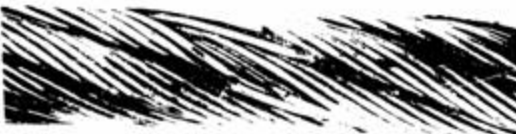
Cliché 3 - Roturas de alambres en un mismo punto. Justifica una operación posterior si ésta es la peor condición que puede aparecer un día.
