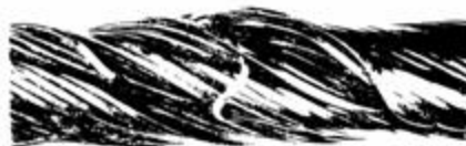
Cliché 22 - Efecto acumulativo de las alteraciones Fuerte desgaste de los alambres de relleno que han sufrido un laminado que ha provocado su aflojamiento y un principio de deformación en ceta. Pueden observarse numerosos alambres rotos El cable debe retirarse inmediatamente
