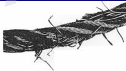
Cliché 21 - Ejemplo de un cable salido de una garganta de polea y atascado Esta ha producido una deformación y rotura de alambres así como la rotura parcial de cordones El cable debe ser retirado inmediatamente
