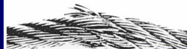
Cliché 6 - Roturas de alambres a la altura de la polea profunda sobre una pequeña longitud de cable. El cable debe ser retirado.
